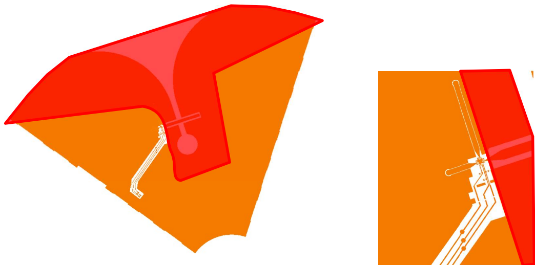
Figure 23 : Vue de la couche bottom du PCB des antennes BBH.
