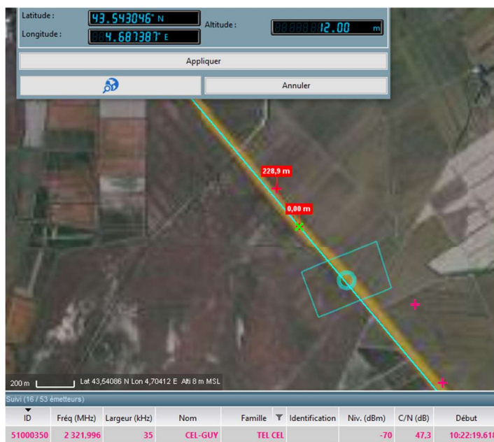
Fig.185 – Mesure de précision de suivi pour géné 2322MHz
