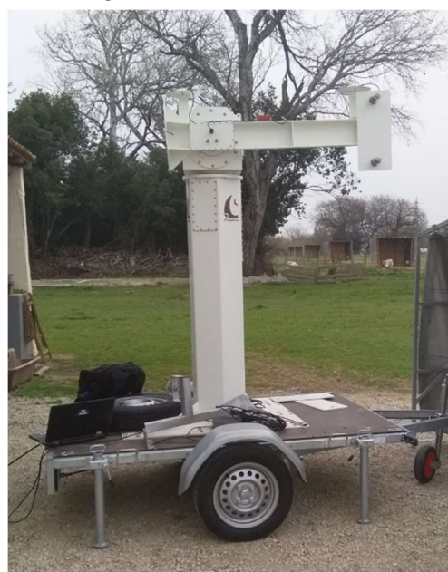
Fig.31 - Vue du positionneur pour antenne seul
