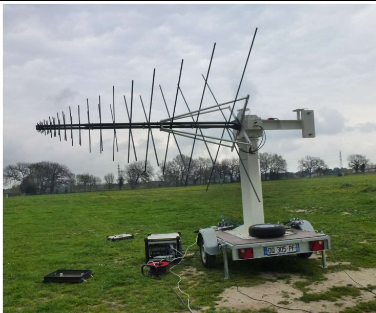
Fig.28 - Antenne pour calibration bande basse sur positionneur
