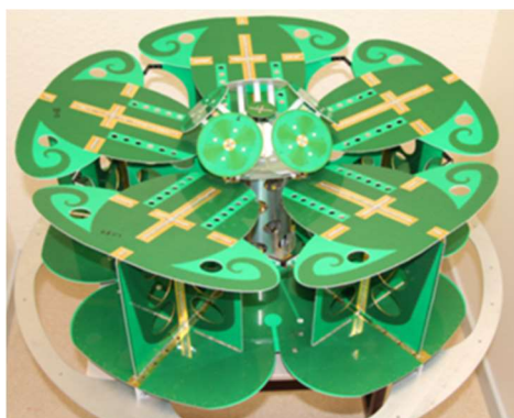
Fig.27 - Antenne FlashHawk et ses 21 antennes
