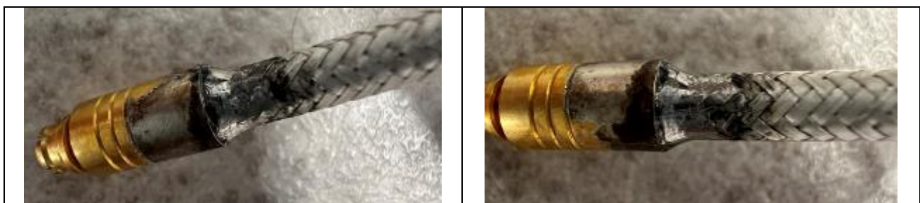
Figure 14 : Dissections des cordons de test SMP (session 3)
