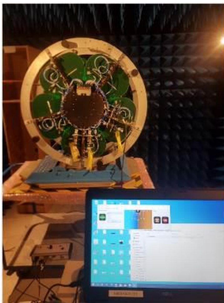
Figure 4 : Photographie du RA dans la CSA
