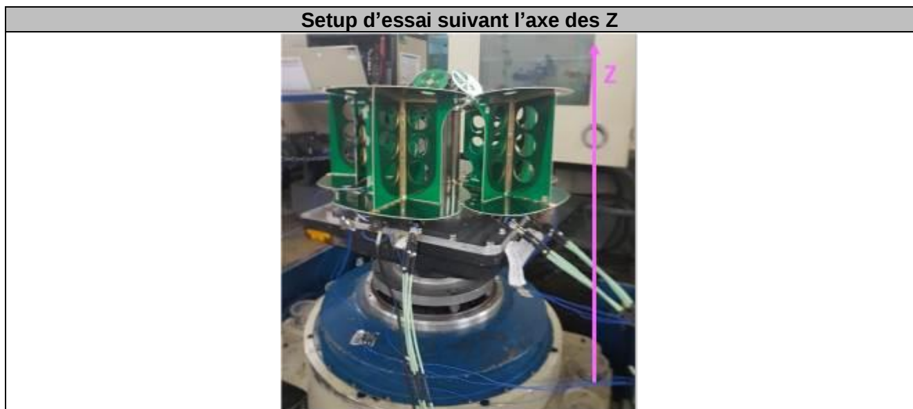
Figure 51 : Photographies du RA sur le pot vibrant suivant les trois axes du repère
