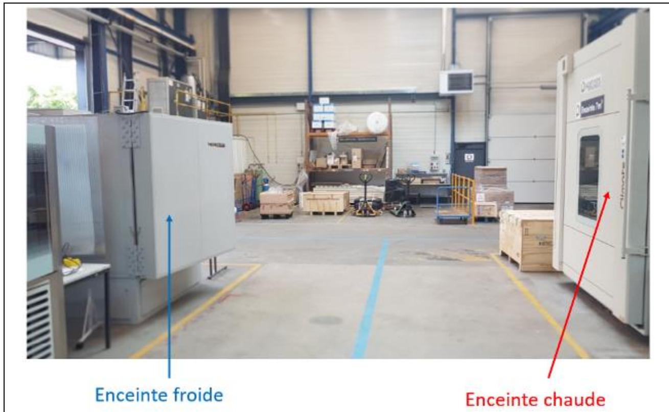
Figure 37 : Emplacement des deux enceintes climatiques, essai givrage
