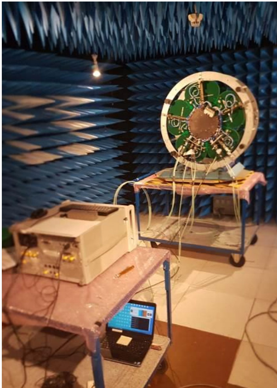
Figure 56 : Photographie du RA dans la CSA
