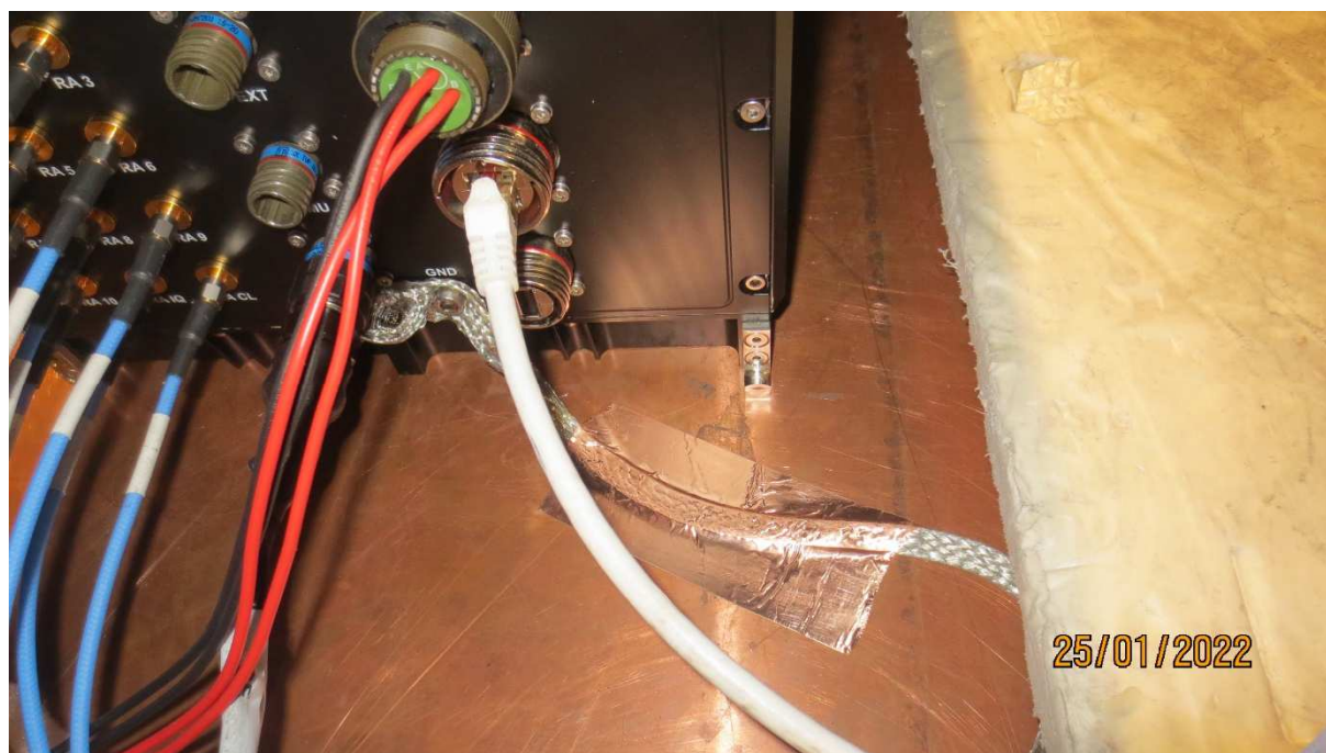
Connexion du ordinateur au plan de masse de référence
