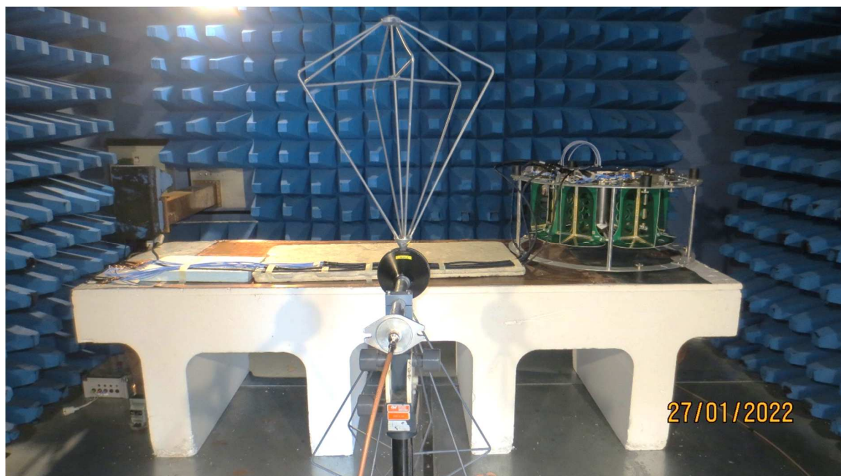
Mesure entre 30MHz et 200MHz (antenne biconique) Configuration n°2
