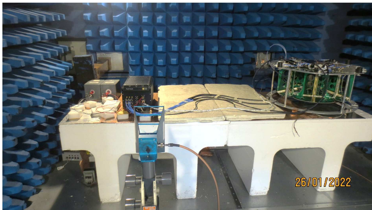
Mesure entre 1GHz et 18GHz (antenne cornet) Configuration n°1, mesures côté calculateur
