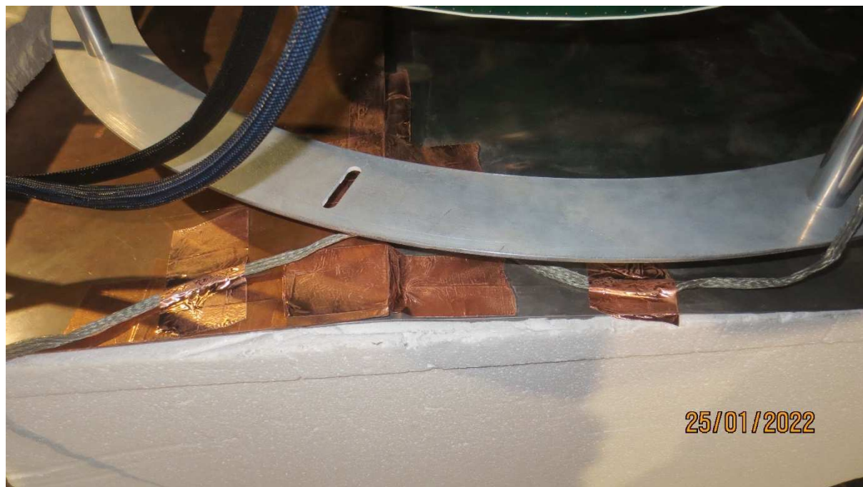
Connexion de l'antenne au plan de masse de référence
