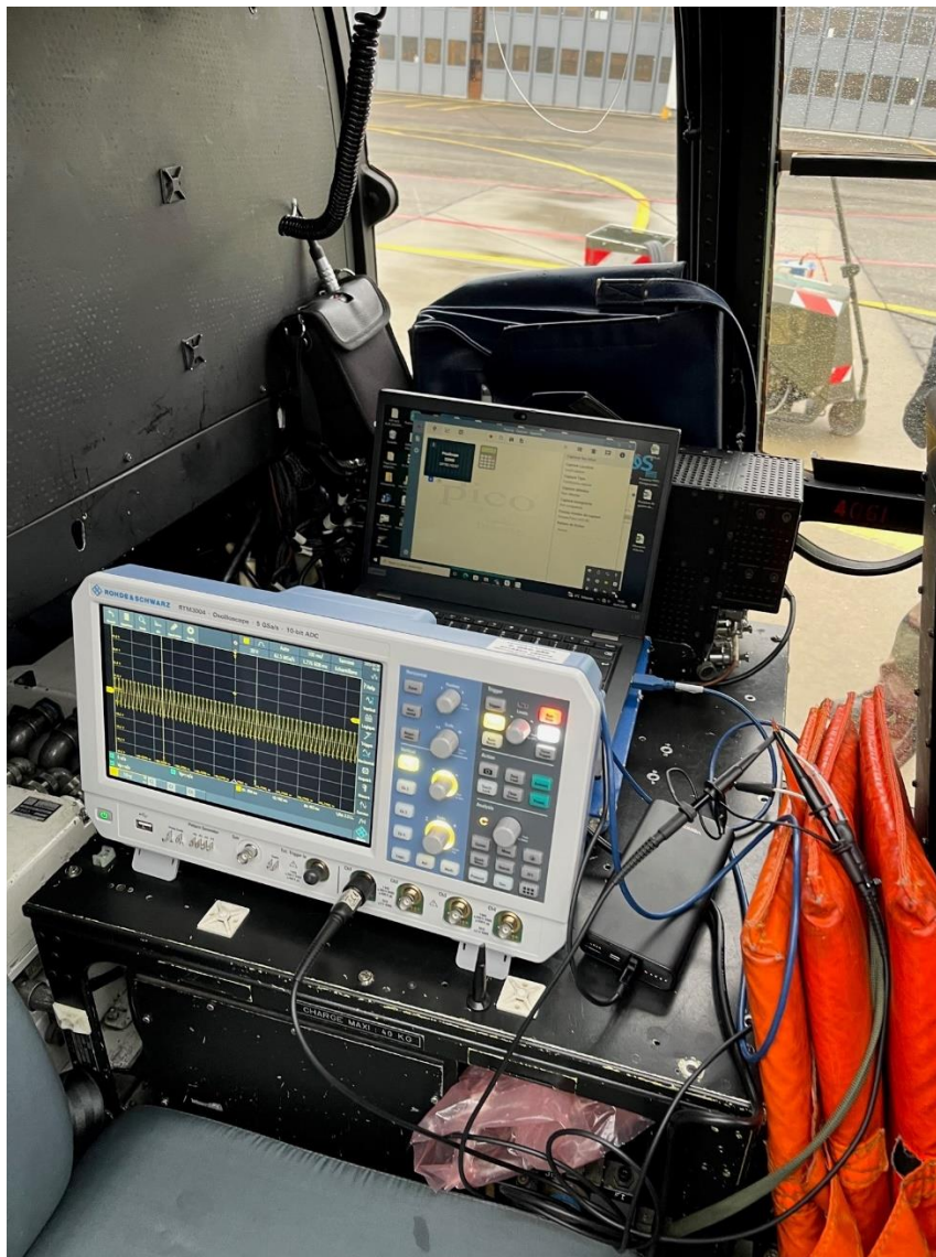
Figure 2 : Instruments de mesure connectés à la prise de servitude 28V
