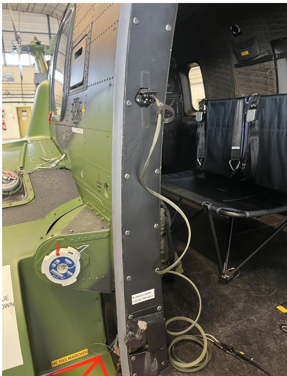
Figure 5 : Câblage de la sonde d'oscilloscope sur la prise de servitude 28V
