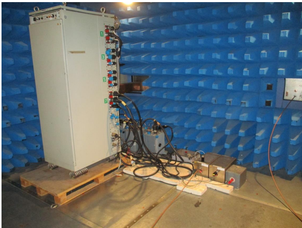
Vue générale de l'installation pour l'essai CE102
