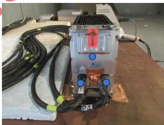
±15kV sur la face avant et deux torons de MU NG R.A.S
