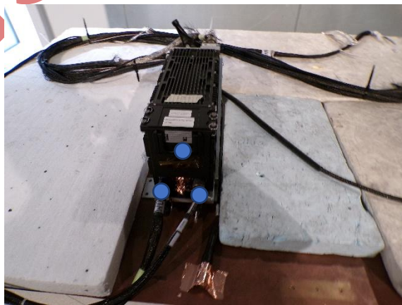
\pm 15\text{kV} sur la face avant et deux torons ECHEC problème sortie audio
