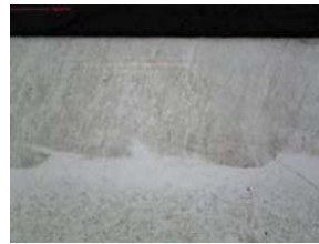
Coupe du dépôt avec zone de dilution
