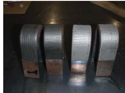
Échantillons plats en acier, pliés après rechargement : INCONEL 625 (à gauche) et WC/NiCr (à droite)
