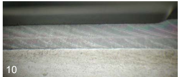
Stellite ® 6 sur 316L, 3mm : Excellente liaison, interface avec faible dilution, absence de défaut
