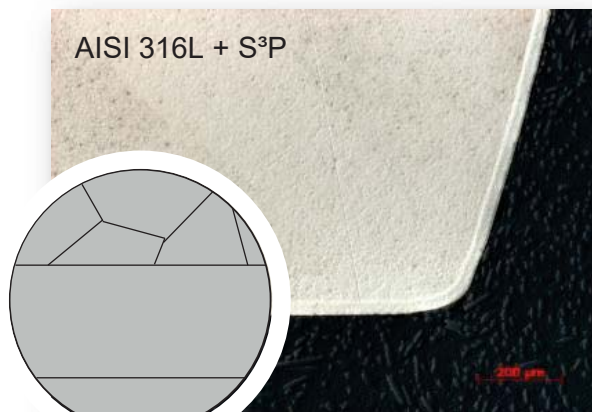
S-Phase austénite supersaturée sans précipitation
